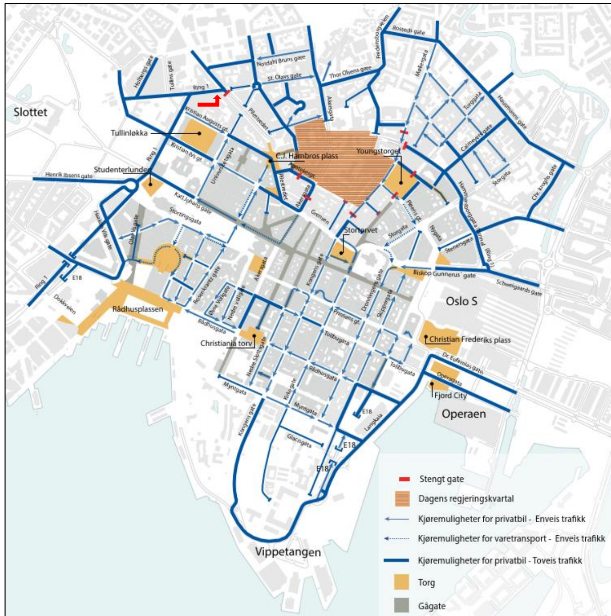
Figur 12: Trafikksystem med Hammersborg- og Vaterlandstunnelen stengt, Anleggsfase 2
